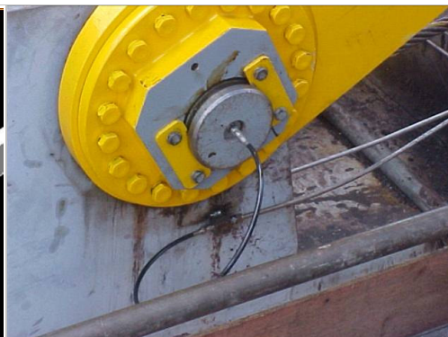
Flange excêntrica mantido e feito melhorias na lubrificação. Fonte: Autores (2003)
